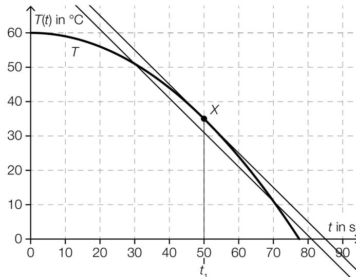
Die Stelle  $t_1$  kann grafisch ermittelt werden, indem derjenige Punkt  $X$  am Graphen von  $T$  gesucht wird, in dem die Tangentensteigung genauso groß ist wie die Steigung der eingezeichneten Sekante (d. h., dass die beiden Geraden parallel liegen müssen).
