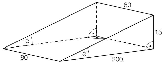
Die Rampe besteht aus Beton. Die Dichte von Beton beträgt rund  $2,4 \text{ kg/dm}^3$ .
